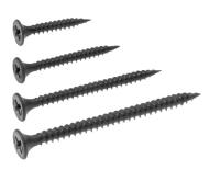
**Produktbeschreibung:** Typ TMN nach DIN EN 14566. Aus Stahl, spezialbehandelt, schwarz phosphatiert, nach DIN 18182-2, mit Trompetenkopf, ausgewalzter Spitze, Kreuzschlitz PH Gr. 2 und Doppelganggewinde.
