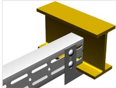
Mit Hilfe der Rigips WST – Trägerklemme mit Langloch wird der Anschluss von Weitspannträgern auf den Flanschen von Stahlträgern hergestellt. Somit kann auf einfache Weise eine Lagesicherung des Weitspannträgers in den Systemen L und XL erfolgen. Die Rigips WST – Trägerklemme mit Langloch wird aus verzinktem Stahlband gefertigt und verfügt über das zur Montage notwendigen Langloch. Eine zusätzliche Verschraubung der Trägerklemme an der Unterseite des Flansches hat zu erfolgen.
