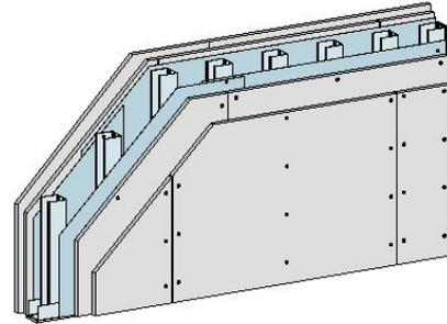
Stahlblechtafeln (max. 1.000 x 2.000 mm) werden auf beiden Wandseiten auf die Ständerprofile genietet. Hierbei ist darauf zu achten, dass die Stahlblechtafeln rundum überlappend (ca. 100 mm) anzuordnen sind. Die Vernietung erfolgt in den Eckpunkten und 1x in jeweiliger Blechmitte mit den CW Wandprofilen.
