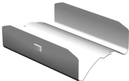
Rigips Deckenprofilverbinder dienen zur Längsverbindung von Rigips C-Deckenprofilen 60/27. Somit können auf einfache Weise tragfähige Stöße von Grund- und Tragprofilen im Deckenbereich durch den passgenauen Rigips Deckenprofilverbinder hergestellt werden.
