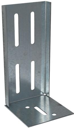
Anschlusswinkel aus verzinktem Stahlblech mit extra langem Schenkel und Lochung zum Anschluss an U-Aussteifungsprofilen 100/40-2. Die Geometrie ist auf die Einlage zwischen die Profilflansche des U-Aussteifungsprofils 100/40-2 abgestimmt. Die Schraubverbindung erfolgt mit Rigips Zargenschrauben M8. Auch anwendbar für U-Aussteifungsprofile 125/40-2 und 150/40-2.
